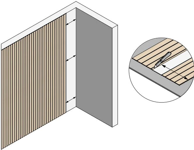
5. Prima dell'ultimo pezzo, misura la larghezza tra il pannello e il muro in almeno tre punti diversi per assicurarti che il pannello si adatti. Usa il righello ThinRibbon per tracciare una linea retta e come supporto quando tagli il pannello con il nostro coltello. Per ottenere un taglio netto, esegui il taglio ripetutamente.
