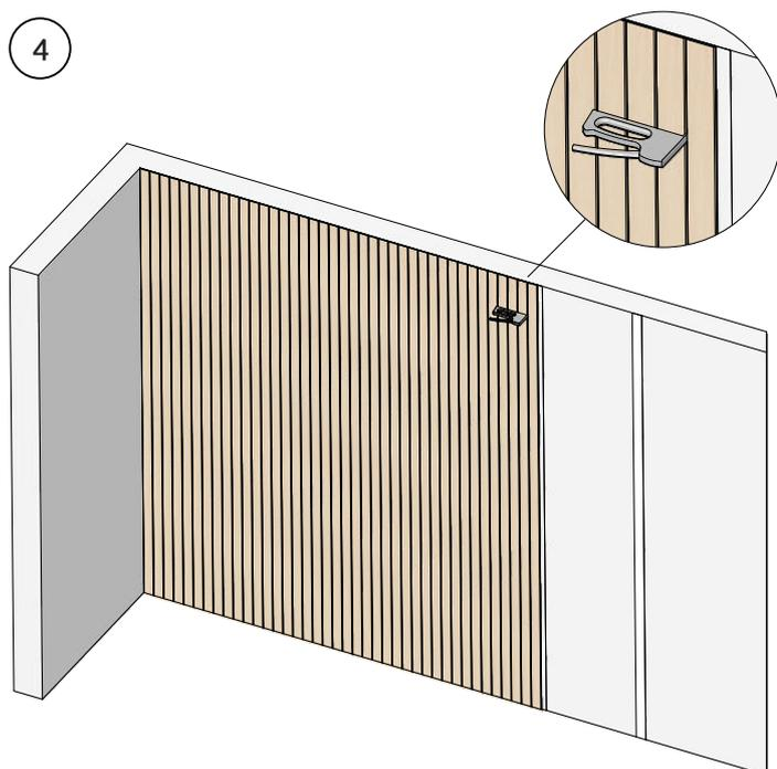
4. Usando la pinzatrice ThinRibbon, pinza alcune volte nelle scanalature nere per mantenere il pannello in posizione durante il montaggio. Per installare facilmente il pannello successivo, controlla attentamente che i pannelli raggiungano la metà del nastro. Ripeti questo schema.
